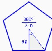
La altura, la mitad del lado y el segmento que une el centro y un vértice forman un triángulo rectángulo.
