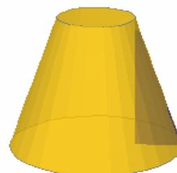
La altura del tronco de cono, la generatriz y el segmento que tiene como longitud la diferencia de los radios de las dos bases forman un triángulo rectángulo.
