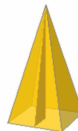
El triángulo formado por la altura de la pirámide, la altura de una cara y la apotema de la base, es un triángulo rectángulo.
