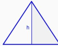
Al dividir un triángulo equilátero o isósceles por la altura se forman dos triángulos rectángulos.
