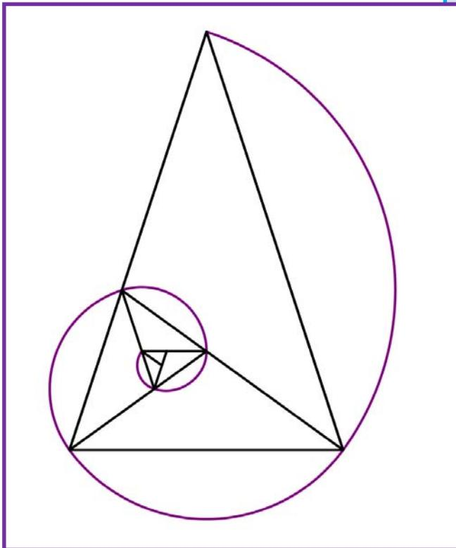
En un pentágono regular la razón entre una diagonal y el lado es  $\Phi$ . Como sabemos construir  $\Phi$ , la construcción de un pentágono regular es muy sencilla:
